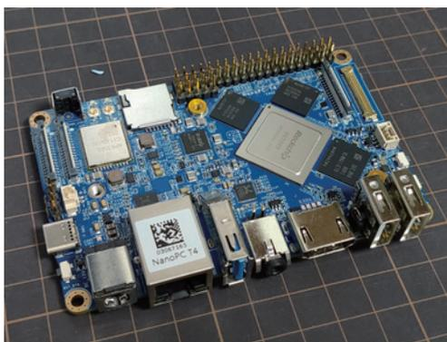
図 1: RK3399 搭載 SBC NanoPi-T4
