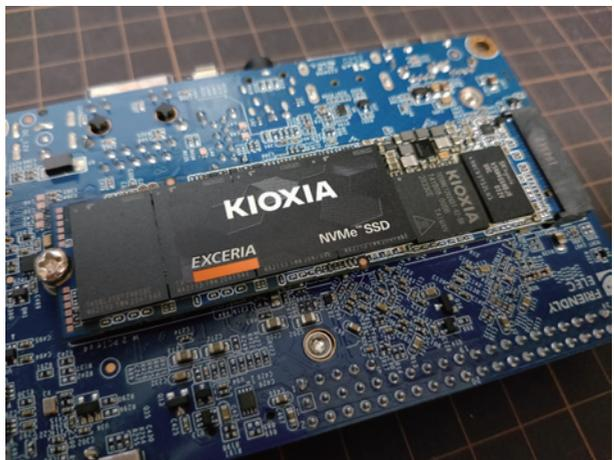
図 2: NanoPC-T4 に EXCERIA SSD を搭載
