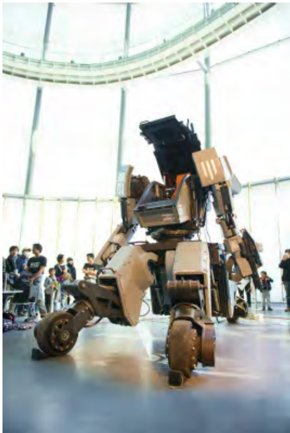
水道橋重工の「クラタス」。全高 4m、重量 4t、人間が搭乗可能なロボットです
