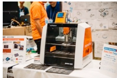
ローランド ディー.ジー. : IAMASとの共同研究 Arduino装着可能な3D切削加工機「SRM-20」
